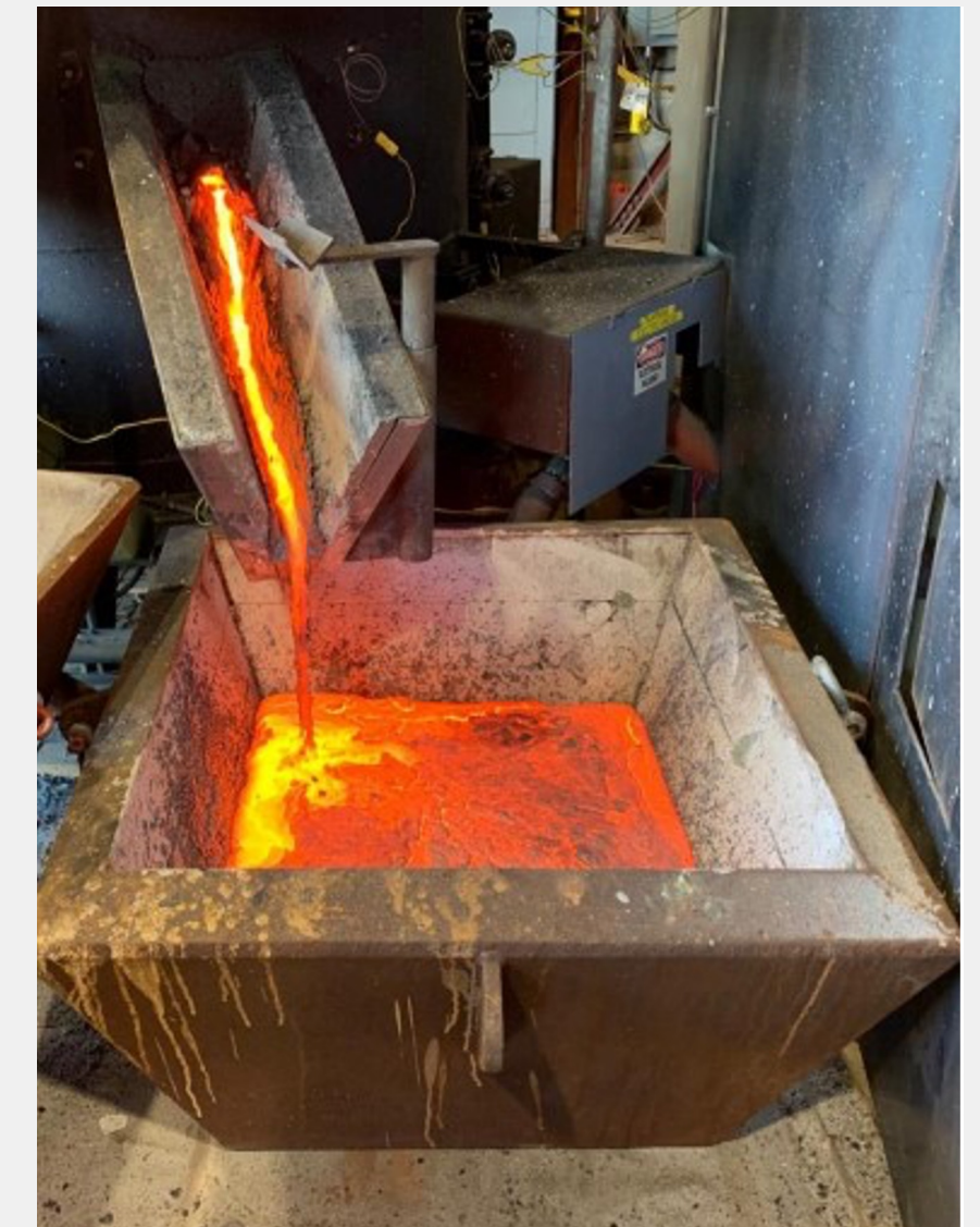
Matte pour post converting. End-product is NiCuCo matte.
